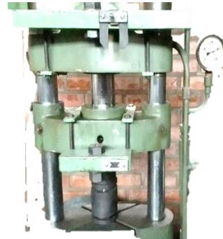
**Figura 3. Prensa hidráulica para compresión del polvo fino de hierro en los troqueles de acero SAE 1045 (Fuente: producción propia)**
