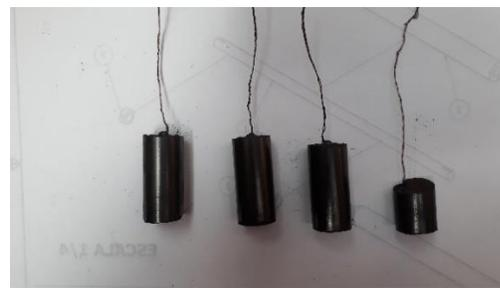
**Figura 2b. Barras conductoras obtenidas por compresión**
