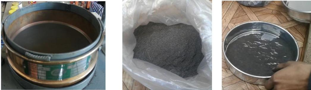
**Figura 1. Tamiz de malla MESH 325 para la obtención de polvo fino de hierro de 45  $\mu\text{m}$  (Fuente: producción propia)**
