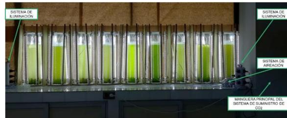
Figura 11. Sistema de producción de biomasa de microalgas
