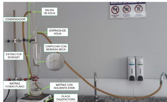
**Figura 15.** Sistema de extracción de aceite de microalgas con empleo del equipo Soxhlet
