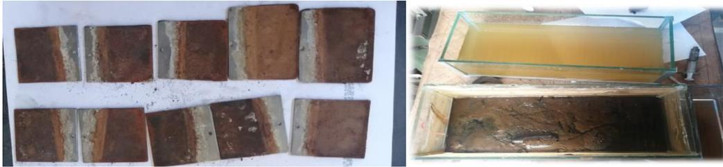
**Figura 5. Deposición y acumulación de nanopartículas de óxido de hierro en las placas del cátodo y en el fondo de la cuba. (Fuente: producción propia)**
